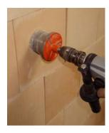
BohrenBohrmaschine mit Bohrkrone
