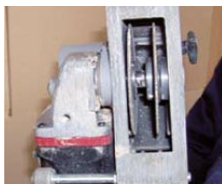
Schlitzfräse für exakte Schnitte verwenden.
